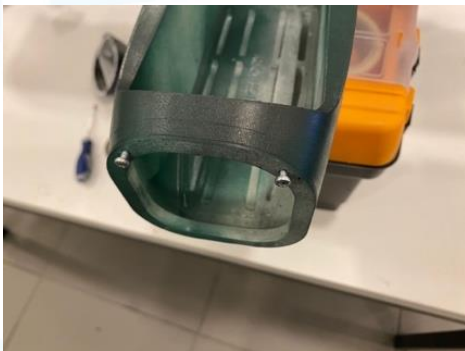
Pirinç yuvasına takılmış M3 vidalar
