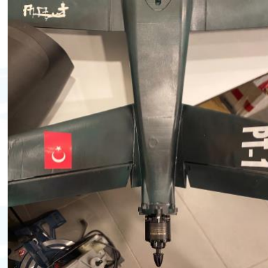
Motor-Motor Yuvası-Gövde birleşimi
